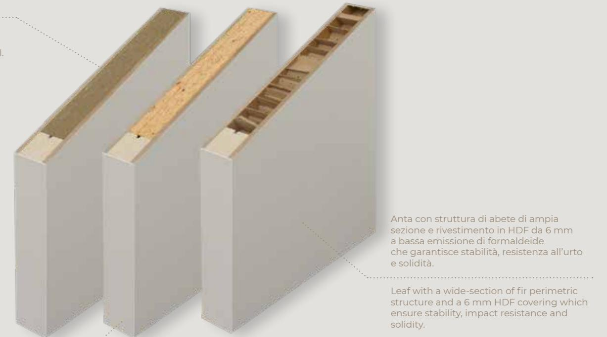
Anta con struttura di abete di ampia sezione e rivestimento in HDF da 6 mm a bassa emissione di formaldeide che garantisce stabilità, resistenza all'urto e solidità.
