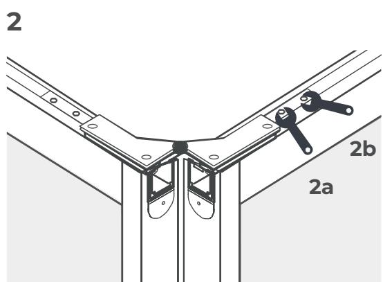
Stringere solo la vite di fissaggio **2a** per trovare la corretta posizione e allineamento, dopo di che stringere la vite di sicurezza **2b** per bloccare la cerniera
